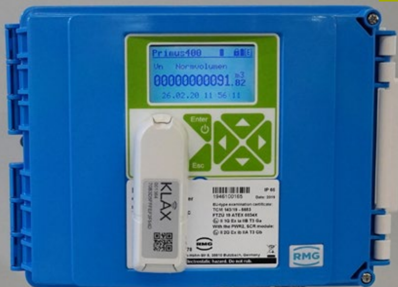
Das „KLAX“-Modul nutzt die optische Schnittstelle des Messgeräts, um Messdaten per LoRaWAN zu übermitteln (Foto: Alpha-Omega Technology GmbH & Co. KG)
